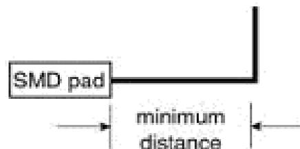
Рисунок 21 – Параметр **SMD to Turn Gap**
