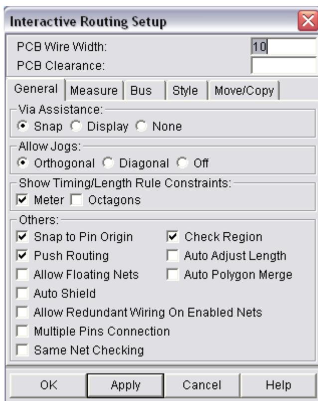
Рисунок 17 – Окно **Interactive Routing Setup**
