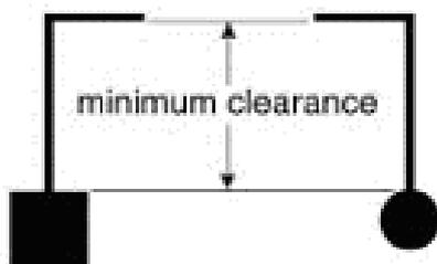
Рисунок 20 – Параметр **Pad-to-Turn Gap**
