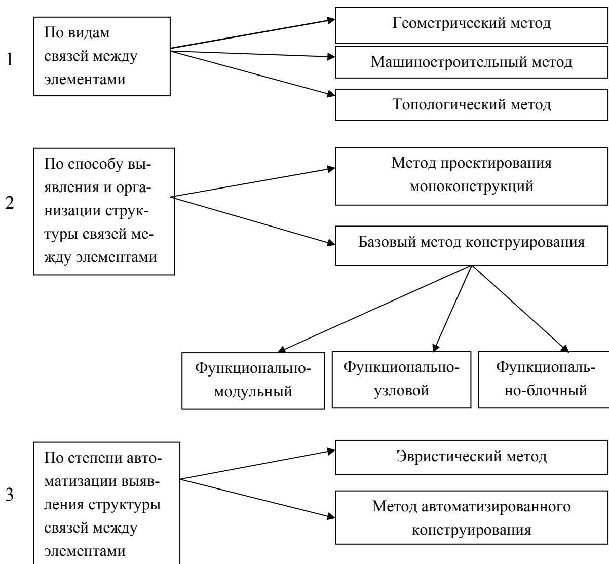
Рисунок 3.1 — Методы конструирования РЭС
